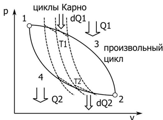
При бесконечном увеличении числа проведенных адиабат отрезки изотерм сольются в одну кривую, представляющую собой контур цикла, и в пределе получим:
